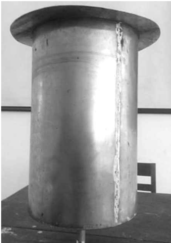
Hình 2. Cối đá lỏng sau khi chế tạo
