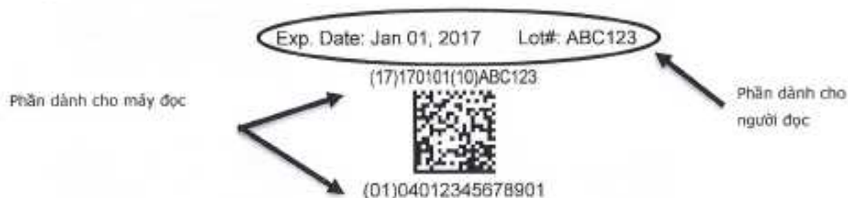
Hình 18 – Ví dụ về nội dung đường liên kết sau giải mã mã vạch Datamatrix
