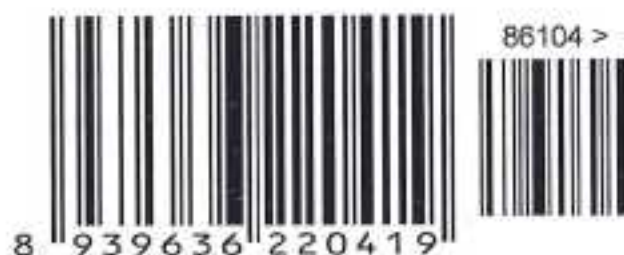
Hình 6 - Mã vạch EAN-13 với mã vạch bổ sung 5 chữ số.
