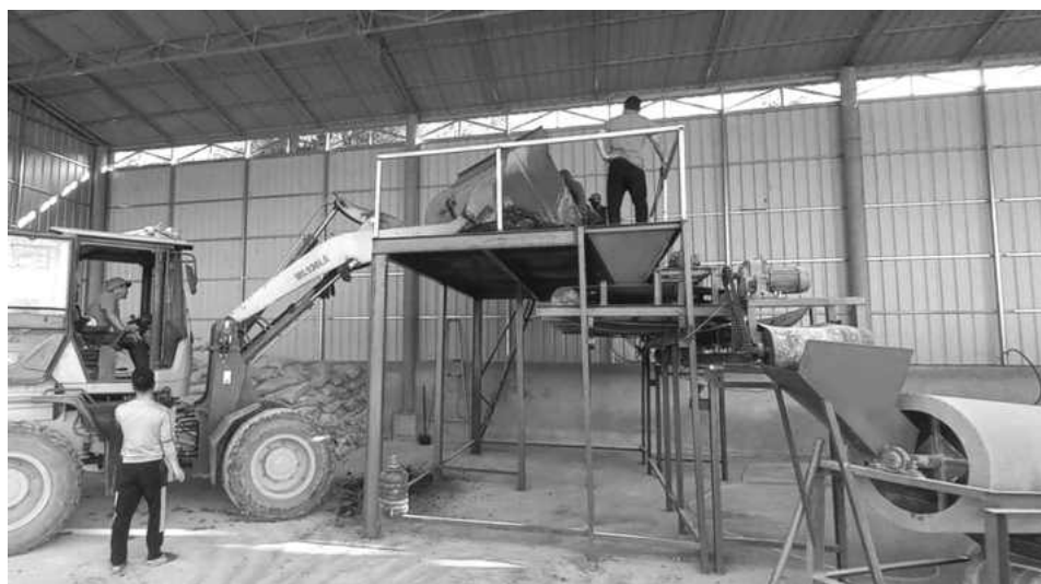
Thử nghiệm sản xuất phân hữu cơ khoáng dạng viên nén nhà chậm
